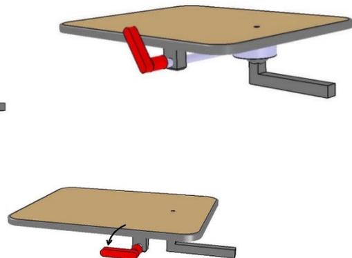
Somit können Sie bei der nächsten Anwendung den roten Hebel einfach in die gleiche Position bringen, um die vorherige Klemmkraft zu erzielen.
